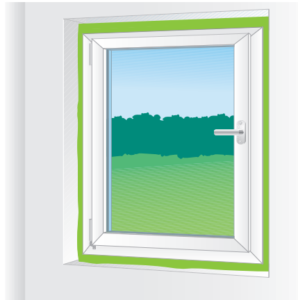
Verfüllung von Fensteranschlussfugen
