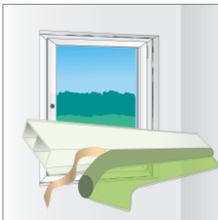
Bild 3: Befestigung der Selbstklebung von illbruck illmod i an der Kammerleiste.
