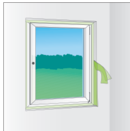
Bild 4: Nach Befestigung der Kammerleiste am Rahmen Aktivierung von illbruck illmod i durch Abtrennung der überstehenden Folie.
