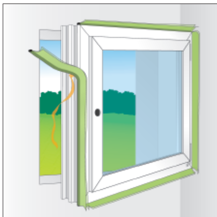
Bild 1: Befestigung der Selbstklebung von illbruck illmod i am Rahmen.
